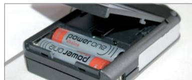
Der Sender kann mit handelsüblichen AA Batterien oder mit Standard AA Akkus betrieben werden.
