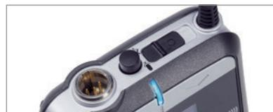
Je nach Anwendungsfall, kann das Mikrofon mit der Mute-Taste stummgeschaltet werden. Zur Sicherheit wird dieser Status durch die blinkende LED und durch „Mute“ im Display signalisiert.
